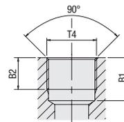
**Einschraubloch (Zylindrisches Gewinde)**
