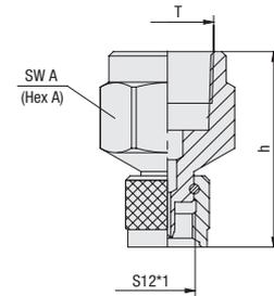
Manometeranschluss für Direktanschluss SMD-12
