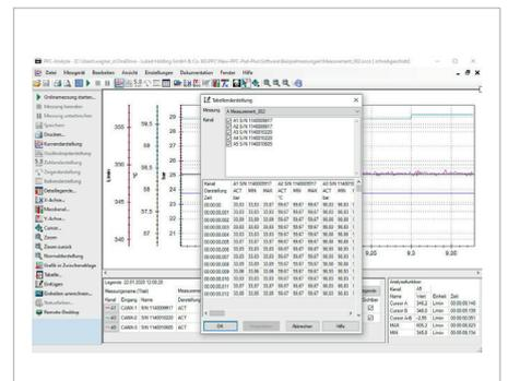
Mit der im Lieferumfang enthaltenen Software PPC-Analyze lassen sie die aufgenommen Kurvenverläufe anzeigen, analysieren und exportieren.
